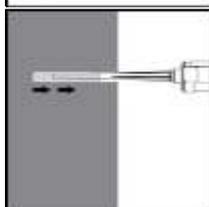
Inyecte el adhesivo empezando por la parte posterior del orificio, retirando lentamente el mezclador con cada disparo del gatillo. Rellene el agujero aproximadamente 2/3 de su capacidad, para asegurarse de que el espacio de separación anular entre el anclaje y el hormigón se llena completamente a lo largo de la profundidad de empotramiento.
