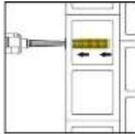
Inserte la boquilla al extremo del tamiz e inyecte la resina hasta que el tamiz se llene al 100%.
