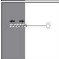
Cepille 2 veces con el tamaño de cepillo especificado (consulte la Tabla 1) insertando el cepillo de acero **Selena** en la parte posterior del orificio (si es necesario con una extensión) en un movimiento de torsión y retirándolo.
