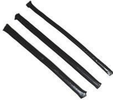
JUNTODAN E es un producto para sellado de juntas, compuesto por betún asfáltico modificado, que se presenta en forma de cordones de aproximadamente 50 cm de longitud y en diversos diámetros. Permite la formación de la junta y su libre movimiento a lo largo del tiempo.
